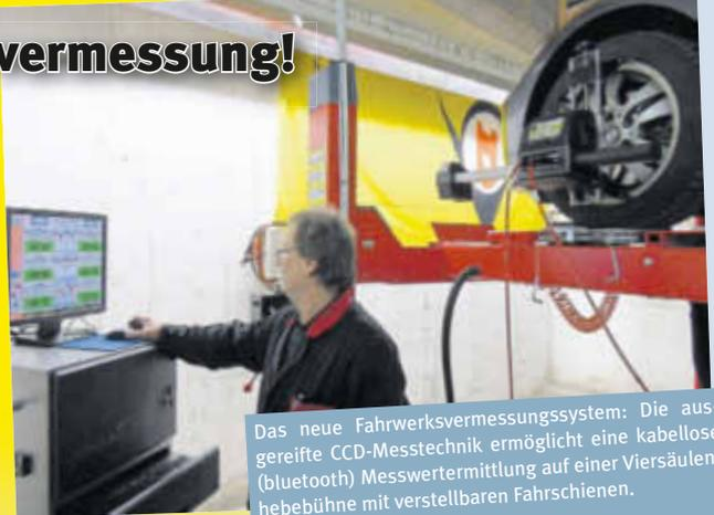
Das neue Fahrwerksvermessungssystem: Die ausgereifte CCD-Messtechnik ermöglicht eine kabellose (bluetooth) Messwertermittlung auf einer Viersäulen-hebebühne mit verstellbaren Fahrschienen.
