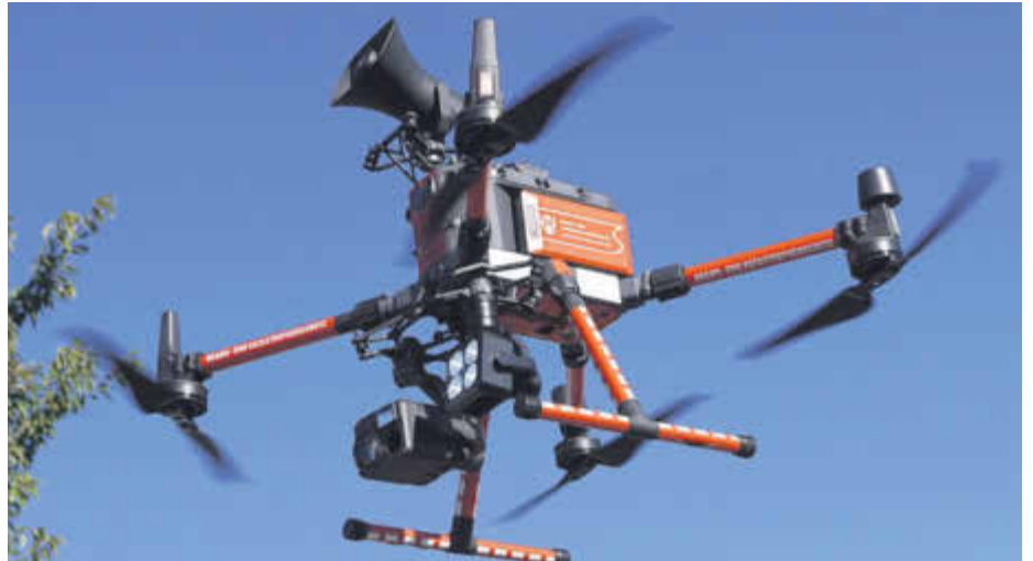
Ausgestattet mit Kameras, LED-Strahler und Lautsprecher - eine der neuen Drohnen der Facheinheit Copter des Brand- und Katastrophenschutzes Trier-Saarburg.
