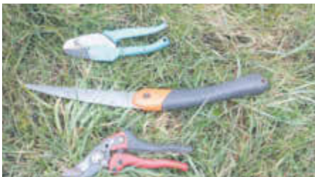
Wichtig für den Obstbaumschnitt: Amboss-Schere, Japanische Säge und Bypass-Schere (von oben)
